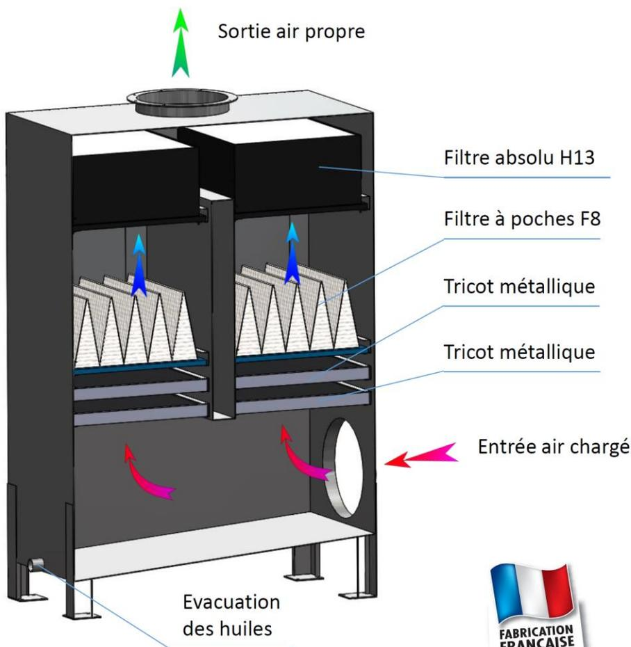
**Etape 1 :** La chambre d'entrée équipée d'un tricot métallique, distribue les flux et filtre les plus grosses particules.
