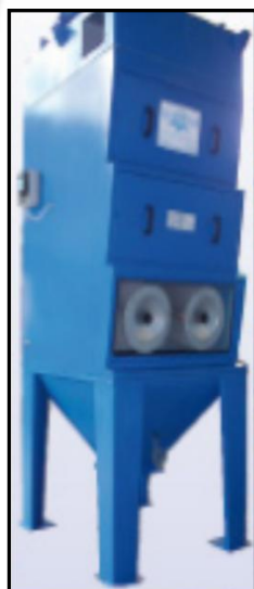
Vue accès maintenance cartouches
